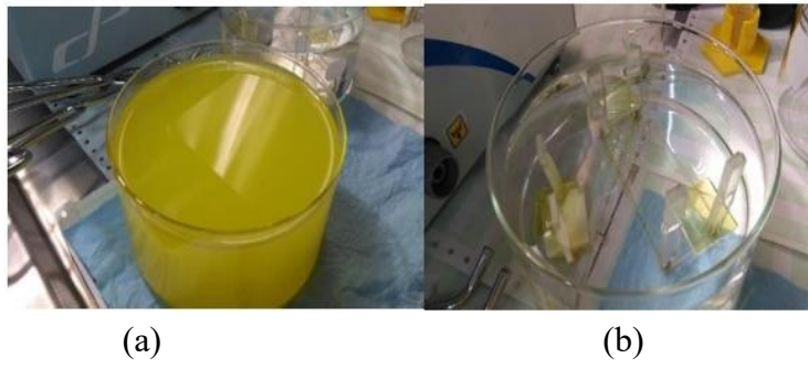
Figura 1. (a) Vaso reactor con 3 lts de solución para depositar un área de 100 \text{ cm}^2 , impacto ambiental negativo, (b) Manipulación de la posición de los sustratos dentro del vaso reactor para disminuir la cantidad de solución para el depósito de películas delgadas de CdS.
