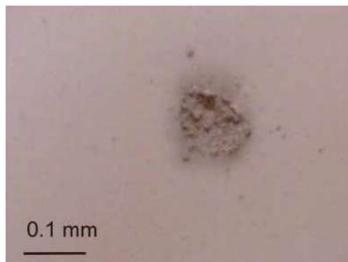
Fig. 5 Huella de un pulso láser sobre una superficie de PVC, generada durante una toma de espectro LIBS.
